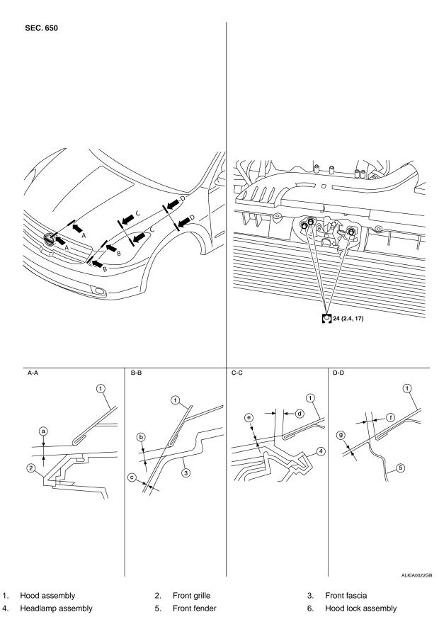
FRONT END HEIGHT ADJUSTMENT AND LATERAL/LONGITUDUNAL CLEARANCE ADJUST-MENT
