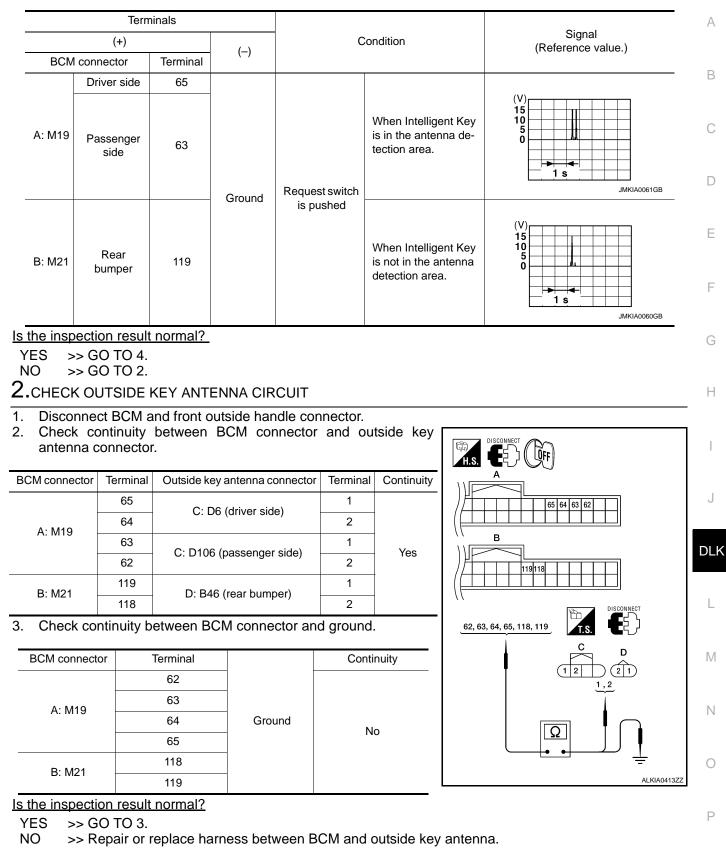
**3.**CHECK OUTSIDE KEY ANTENNA INPUT SIGNAL 2
